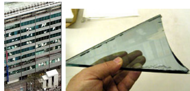
福岡県西方沖地震のガラス落下被害(2005) 13
