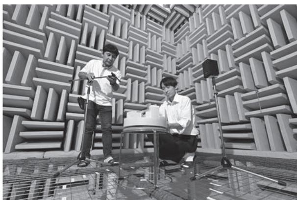
音波を拡散させる音響メタマテリアルの試作とその測定
